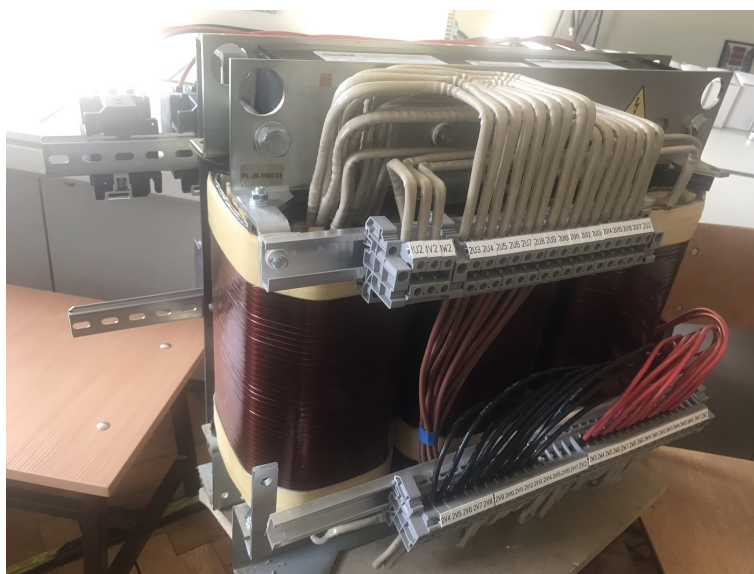
Rysunek 3.3: Transformator wejściowy TW.
